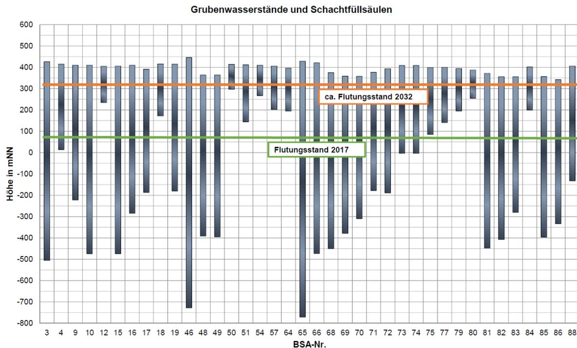
**Abbildung 4: Höhenlage ausgewählter Schachtfüllsäulen und des Grubenwasserspiegels 2017 (grün) und 2032 (rot)**
