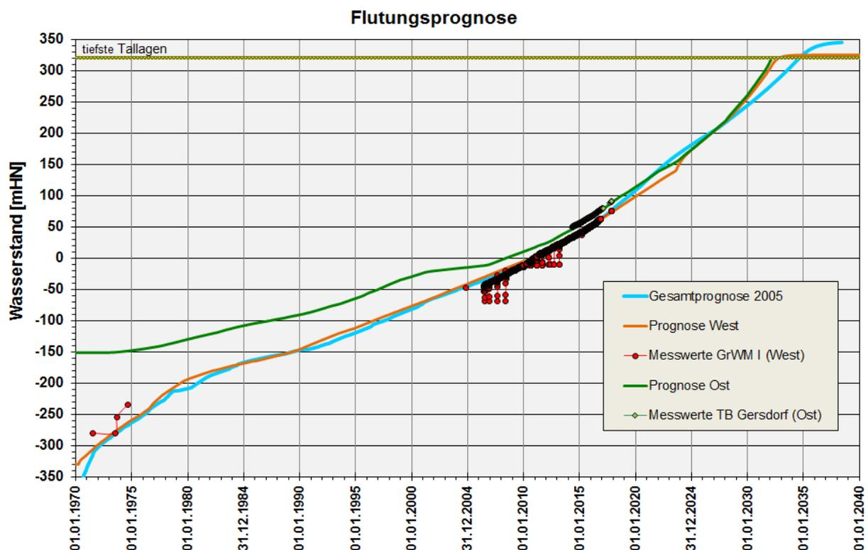
Abbildung 3: Modellierung und Messwerte des Grubenwasseranstieges
