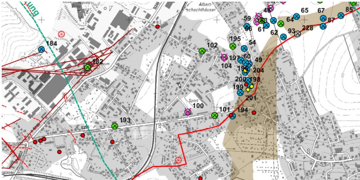
**Abbildung 5: Schächte ✕, Schadstellen und Grubengasaustritte (gelb) in Neu-Oelsnitz im Osten des Reviers; braun hinterlegt: Ausstrich des Oberkarbons an der Tagesoberfläche**
