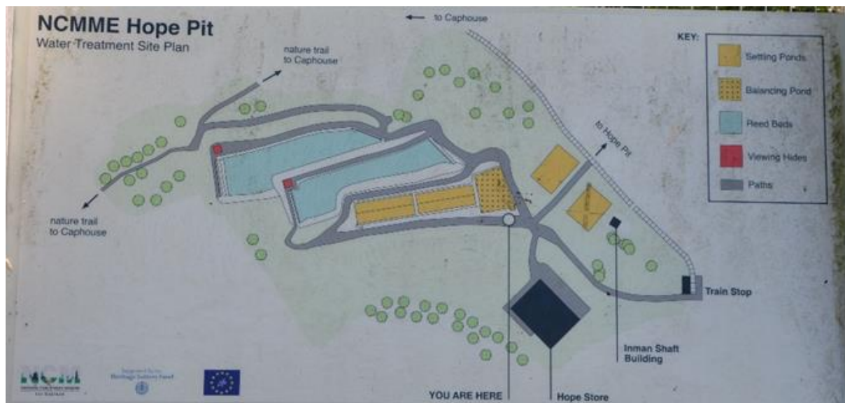
Obrázek 9. Schéma systému na čištění důlních vod Hope Pit ve Velké Británii. Žluté čtverce = usazovací rybníky, žluté obdélníky s černými tečkami – vyrovnávací nádrž (Obrázek 10), modré obdélníky – aerobní mokřady s povrchovým tokem (Obrázek 11).
