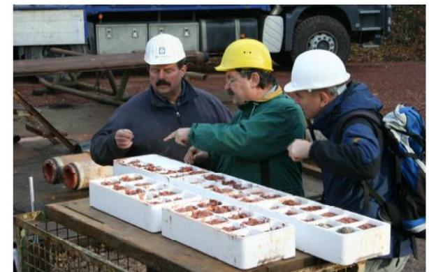
Bild 10: Ablage und Bemusterung der Spülungsproben in Polystyrol-Fächerkisten (06.11.2013)
