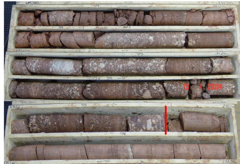
Abb. 26: Bohrung Oelsnitz 1A/2003, Basiskonglomerat des Großzyklus 2 der Unteren Leukersdorf-Subformation bei 274,8 m
