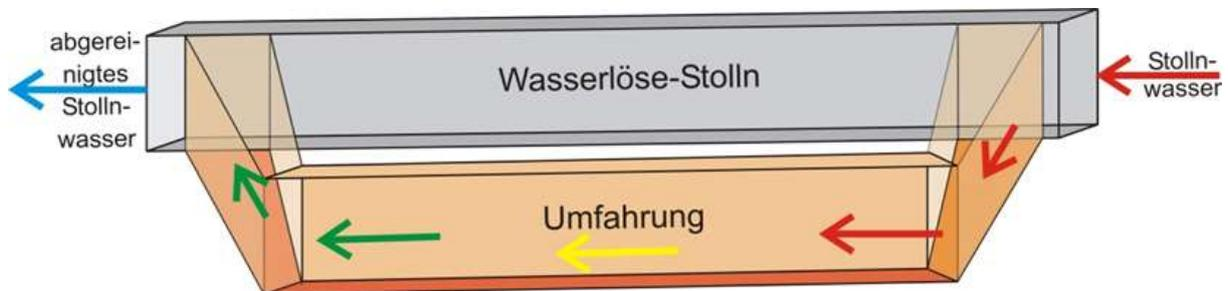
**Abbildung 2: Konzept einer Reaktionsstrecke (Adsorption an Kalksand) in der Umfahrung des Tiefe Hilfe Gottes Stolln im Bergbaurevier Zinnwald**
