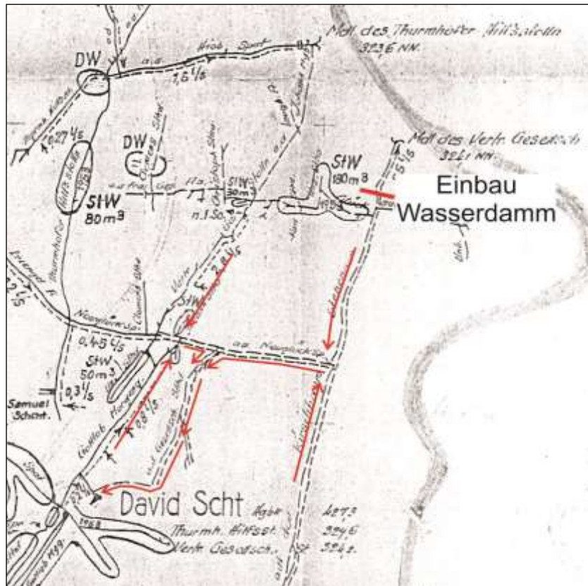
Abbildung 24: Konzept zur Umleitung des Stollnwassers des VGS.
